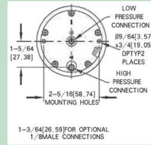
**BESTACE P5000 系列迷你紧凑型微差压表**采用可变透镜表盘设计，尺寸小巧但便于读数。直径 2-5/8" 的单孔即可实现产品的面板安装。P5000 外壳为含玻璃纤维的 ABS，价位低但能确保足够精度和可靠性。标准压力连接是适合于 3/16" ID 管道的带毛刺装置；可安全操作的压力达 30PSI。产品的过压保护是通过与隔膜相连的气膜来实现的。事故发生时的过大压力也不会损坏产品。
