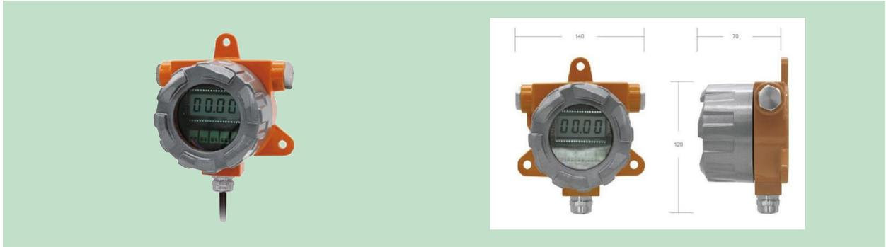
**BESTACE 851 系列防爆微差压变送器**, 可以检测正压、负压和差压, 最小量程可低至 100 Pa, 最大量程可达 10 KPa。其采用进口压力芯片, 敏感元件采用扩散或离子注入等工艺形成电阻并连接成惠斯通电桥, 用微机械加工技术在电桥下形成压力敏感膜片。当压力作用在膜片上时, 电阻值发生变化并且产生一个与作用压力成正比的线性化输出信号。
