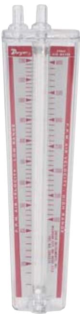
因为 460 风速计应用简单快速，在维修空气净化装置，加热和通风设备等领域很受欢迎。
